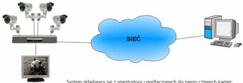
System składający się z rejestratora i podłączonych do niego czterech kamer; zarządzanie przez sieć
