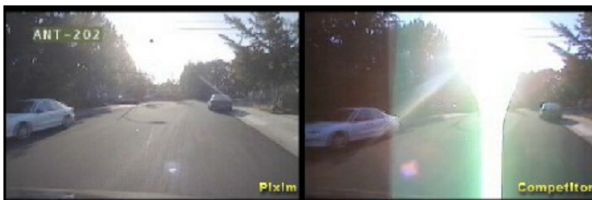
Kamera SN-587C/A/10 z przetwornikiem Pixim i zwykła kamera w warunkach nagłej zmiany oświetlenia
