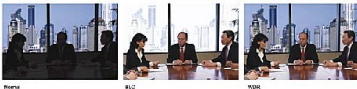
Kamera SN-587C/A/10 M11205 z przetwornikiem Pixim znacznie przewyższa w monitoringu "pod światło" kamery z funkcją BLC (Back Light Compensation)
