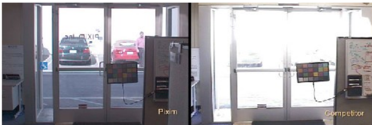
Obraz z kamery SN-587C/A/10 M11205 z przetwornikiem Pixim oraz ze zwykłej kamery
